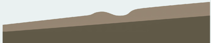
Figure 40: Vue en profil d'une barre d'eau.
